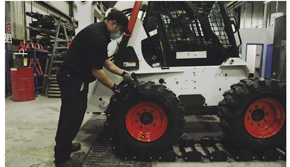
5. Tire de los extremos de la oruga para colocarlos sobre los neumáticos.
