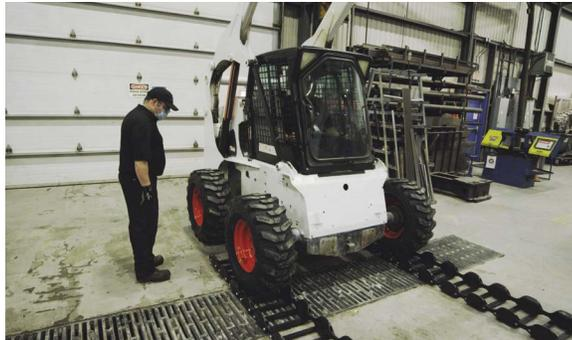
4. Centrando los neumáticos de la máquina en la oruga, conduzca cuidadosamente sobre la oruga.
