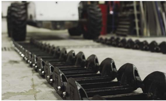
1. Extienda la oruga en el suelo frente al vehículo con el patrón de la banda de rodadura hacia abajo.
