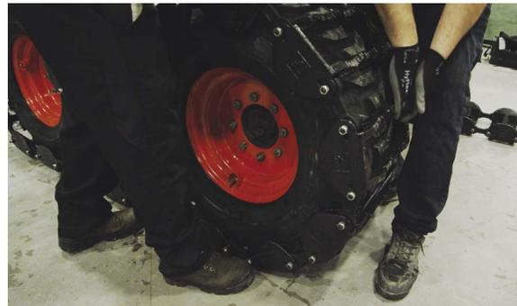
6. Use la correa de la rueda dentada para unir los extremos. Es importante respetar una distancia de un eslabón y medio de ambos lados del centro de fijación.
