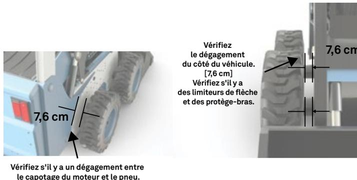
Vérifiez s'il y a un dégagement entre le capotage du moteur et le pneu.
