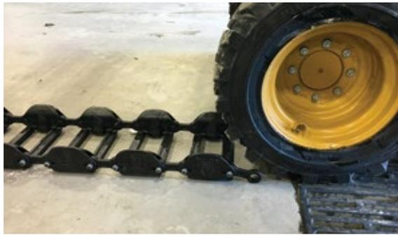
1. Dépliez la chenille sur le sol devant le véhicule, avec le profil de bande de roulement contre terre.
