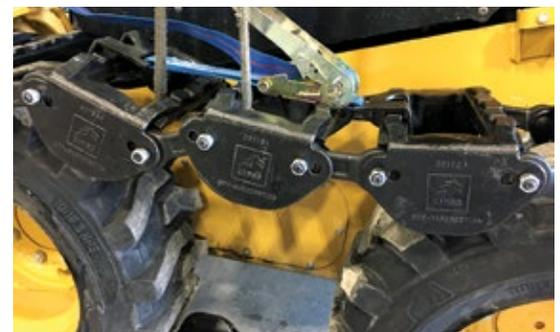
11. Vérifiez l'affaissement de la chenille; un affaissement entre 1,58 cm et 2,54 cm (1 et 2 po) est recommandé.
