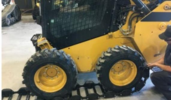
4. Positionnez les pneus du véhicule au centre de la chenille et roulez soigneusement sur cette dernière.
