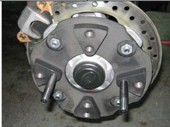
Tout en regardant dans les trous de vissage 1, 2 et 3 du bras d'aluminium de la structure, alignez le moyeu en tournant le barbotin, ce qui vous permettra de voir le trou du moyeu.
