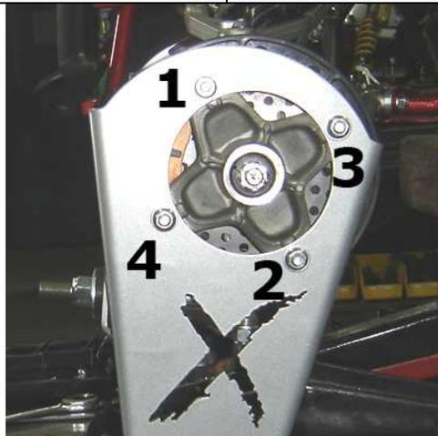
Retirez la vis et les douilles de la plaque de fixation puis fixez la tige stabilisatrice à la plaque de fixation en prenant soin de garder les douilles coniques de chaque côté de la rotule.
