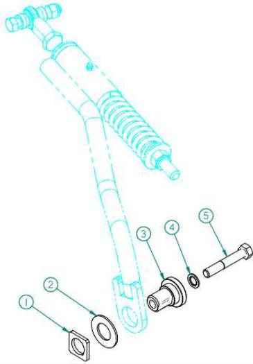
Retirez la vis et les douilles de la rotule à l'extrémité de la barre puis fixez la barre stabilisatrice à la plaque adaptation en prenant soin de garder les douilles entre la rotule et le support de la barre. Si votre support comprend 3 trous de positionnement, utilisez le trou du centre.
