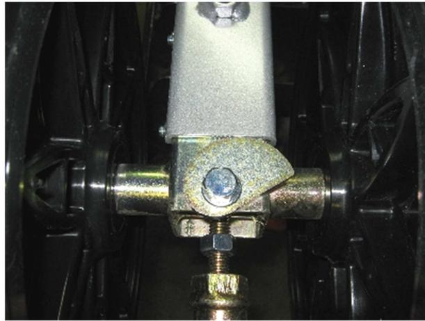
Ensuite vissez la tige du tensionneur jusqu'à obtenir la tension recommandée.
