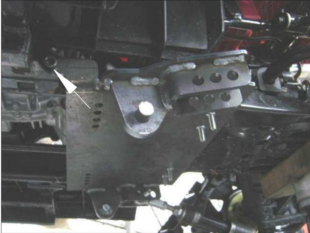
Retirer les boulons existants, poser la pièce 03PA-277 et poser les boulons fournis (voir flèche ci-dessus).
