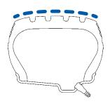
Camso BHL 530 передняя шина для погрузчиков с обратной лопатой имеет усиленный каркас для более высокой устойчивости под нагрузкой и более плоский протектор
