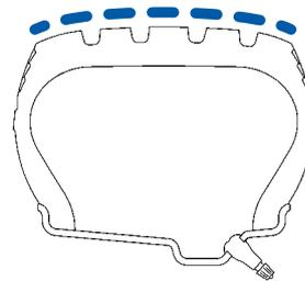
Il Camso BHL 530 per le ruote anteriori delle terne presenta una carcassa più robusta del normale in modo da **migliorare la stabilità della macchina sotto carico** riducendo la curvatura del battistrada.
