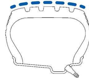
Der Solideal MR F3 Vorderreifen für Baggerlader verfügt über eine stärkere Karkassenkonstruktion für **verbesserte Stabilität unter Last** mit reduzierter Profilwölbung.
