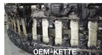
Im Belastungstest versagten die Ketten eines Wettbewerbers im Gegensatz zu Camso-Ketten, deren Profilblöcke sich über die gesamte Kettenlänge auch nach 196 Stunden in gutem Zustand befanden.
