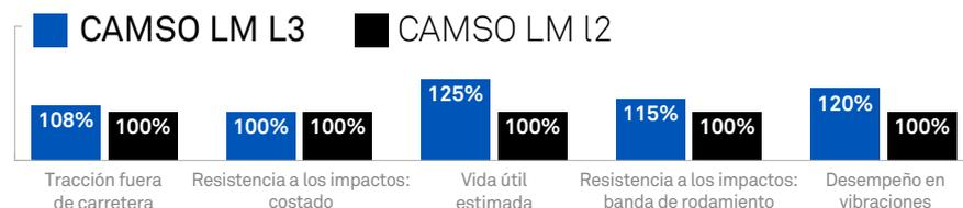
La durabilidad y la estabilidad son aspectos clave en aplicaciones de cargadores en superficies duras y mixtas. El neumático Camso LM L3 mejora la durabilidad de la banda de rodamiento y la resistencia a los impactos gracias a su espacio entre bloques optimizado y su banda de rodamiento de diseño no direccional. Además, su carcasa reforzada mejora la estabilidad.
