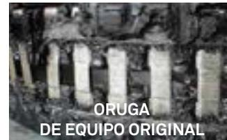
Después de 196 horas de prueba, las orugas de la competencia fallaron frente a Camso, cuya barra de la banda de rodamiento se mantuvo en buenas condiciones en toda la oruga.
