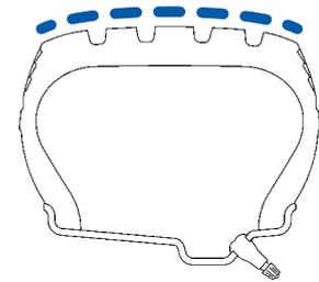
El neumático delantero Camso BHL 530 para retroexcavadoras posee una construcción de carcasa reforzada que brinda **mayor estabilidad bajo carga** con menor desgaste irregular de la banda de rodamiento.
