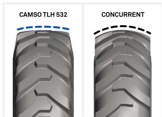
Le pneu Camso TLH 532 a été conçu pour offrir une solution de très grande qualité pour les chariots télescopiques, convenant à une vaste gamme d'applications. Le profil plus aplati de la bande de roulement du pneu TLH 532 permet de maintenir plat le sommet de la carcasse lorsqu'il est gonflé, de manière à **améliorer la stabilité et à permettre une usure uniforme de la bande de roulement.**
