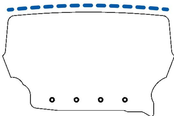
La llanta Camso SKS 786S es una llanta sólida de gran tamaño para minicargadores, que mantiene las dimensiones originales del equipo, con un perfil completamente plano de banda de rodamiento para proporcionar **mayor estabilidad y durabilidad** en aplicaciones de superficies duras. Posee núcleos de acero que impiden que la llanta se deslice en el rin reutilizable.
