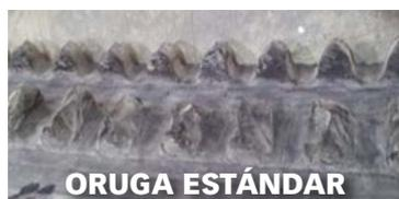
Después de 180 horas de agresivas pruebas, la oruga estándar falló, mientras que la oruga Camso continuó operando 20 horas más. Esto significa que la oruga Camso ofrece al menos un 10% más de vida útil.
