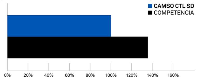
Un test demostró que las orugas de Camso tenían un 36% menos de resistencia al rodamiento que el otro competidor en orugas de alta calidad.
