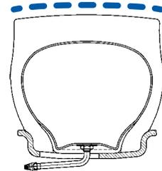
Le pneu pour compacteurs Camso CMP 576 présente une construction robuste de la bande de roulement qui comporte des sous-protecteurs pour maintenir la carcasse plate. Cela permet d'assurer une usure uniforme de la bande de roulement et d'égaliser la pression au sol.
