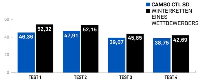
Tests auf Eis haben ergeben, dass Ketten vom Typ Camso CTL SD gegenüber der Konkurrenz **eine um 11 % bessere Manövrierfähigkeit aufweisen**. Ein Video mit den Ergebnissen finden Sie unter [bit.ly/1gGPYOf](https://bit.ly/1gGPYOf)
