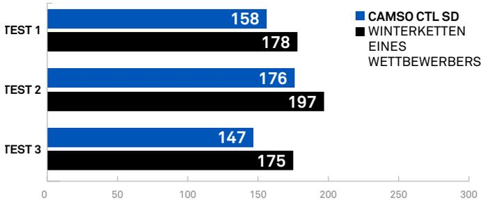
Tests haben erwiesen, dass der Bremsweg von Camso-Ketten auf Eis im Vergleich zur Konkurrenz **um 13 % kürzer** ist. Für den Fahrer bedeutet das: besseres Handling und weniger Schlupf.
