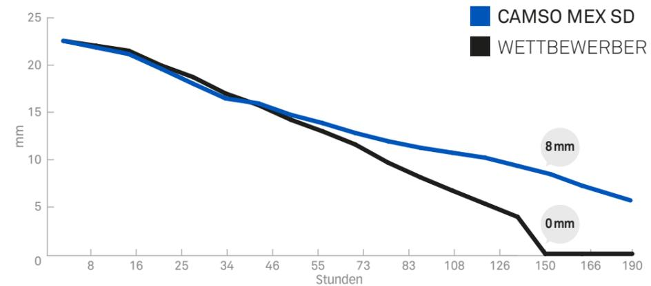
Dieser Test verdeutlicht, dass die Gummimischung der Kettenlauf­fläche bei der Konkurrenz schneller verschleißt als bei Camso. Die beständigere Ummantelung der Karkasse bietet besseren Schutz und trägt so zu einer längeren Lebensdauer bei. Das Ergebnis: **Camso MEX SD bietet eine um 21 % längere Lebensdauer.**
