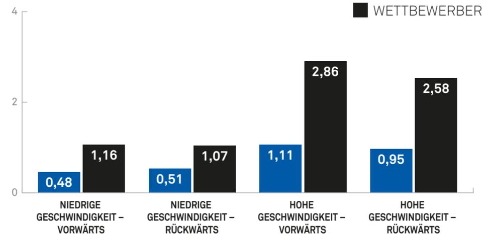
Insgesamt erreichten die Ketten von Camoplast im Vergleich zu hochwertigen OEM-Ketten ein um **59 % geringeres Vibrationsniveau** (unabhängig von Geschwindigkeit und Fahrtrichtung).
