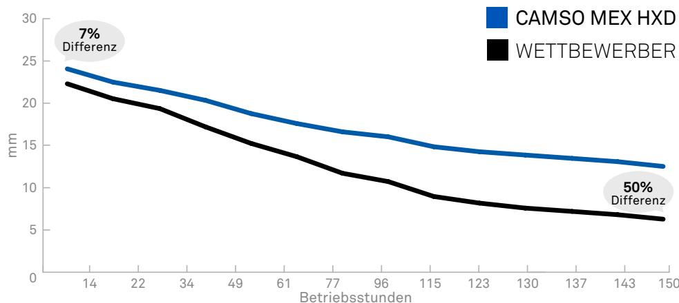
Camso-Ketten verfügen über eine wesentlich dickere Lauffläche als die meisten OEM-Ketten. Die beständigere Ummantelung schützt die Karkasse besser gegen Stich- und Schnittverletzungen und trägt so zu einer längeren Lebensdauer der Kette und weniger Stillstandzeiten bei. Der Verschleißtest beweist: **Die Camso HXD bietet eine um 30 % längere Lebensdauer.**
