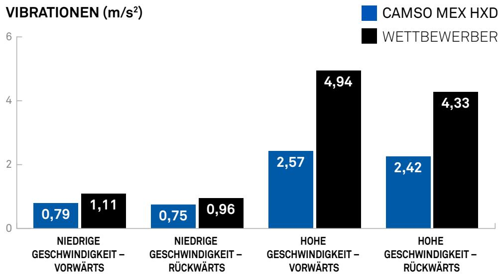
Insgesamt erreichten die Ketten von Camso im Vergleich zu hochwertigen OEM-Ketten ein um 36 % geringeres Vibrationsniveau (unabhängig von Geschwindigkeit und Fahrtrichtung).
