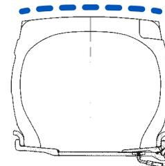
Le pneu WHL 776R présente une bande de roulement à profil plat qui offre une stabilité améliorée, une usure uniforme et une faible pression de contact.
