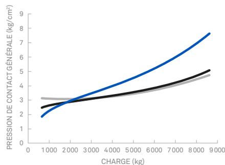
La pression au sol plus élevée du pneu Camso SL G2 permet d'améliorer la traction et la stabilité.
