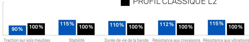
Le profil robuste du pneu Camso WHL 773 offre une stabilité et une résistance aux chocs améliorées par rapport à un pneu L2 standard. Les utilisateurs peuvent s'attendre à un **rendement et une longévité améliorés** sur les surfaces mixtes et dures.
