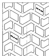
Le pneu Camso SKZ pour chargeuses présente un profil non directionnel unique qui offre **une traction et une résistance à l'usure excellentes** sur les surfaces mixtes et dures.
