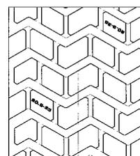
El neumático Camso SKZ para cargadores de ruedas tiene un diseño único de banda de rodamiento no direccional que proporciona **excelente tracción y resistencia al desgaste** en aplicaciones de superficies duras y mixtas.
