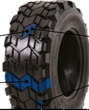
**NICHT LAUFRICHTUNGSGEBUNDENES PROFILDESIGN MIT HOHEM VERHÄLTNISS VON PROFILSTOLLEN ZU PROFILNEGATIV**
