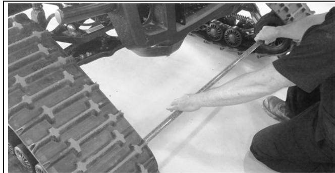
Figure 21 ( Distance entre les pneus avant)
