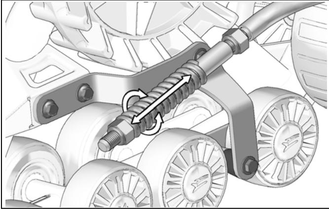
**LUBRICATION OF STABILIZING ARM ROD ENDS**
