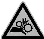
PIÈCES MOBILES - Garder les mains ou les doigts loin des pièces en mouvement. Elles présentent un risque de blessures graves ou de mort. Couper le moteur avant de faire l'entretien des systèmes de chenille.
