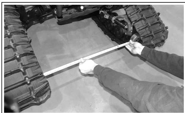
Figure 22 (Distance entre les roues avant)
