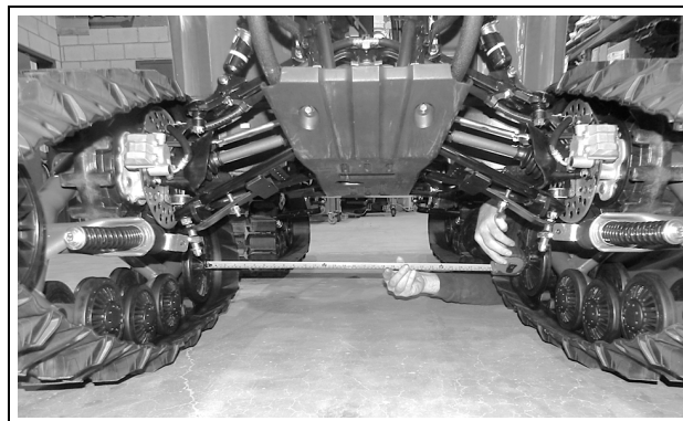
Figure 25 (Distance entre les roues arrière)
