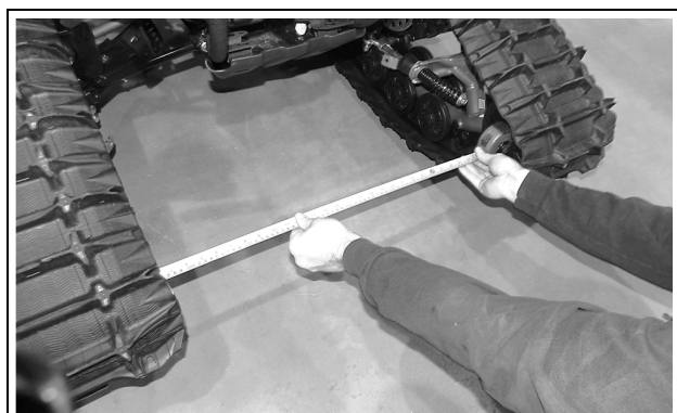
Figure 22 (Distance entre les roues avant)
