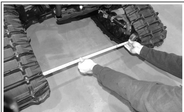
Figure 22 (Distance entre les roues avant)
