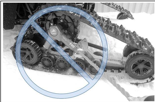
**ATTENTION :** Le câble de remorquage doit être fixé au châssis du véhicule.
