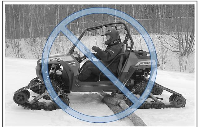
**NOTE :** Certains véhicules utilitaires n'ont pas l'option de verrouillage du différentiel arrière. Pour ces véhicules, éviter la situation mentionnée ci-dessus et effectuer des virages à plus grand rayon.
