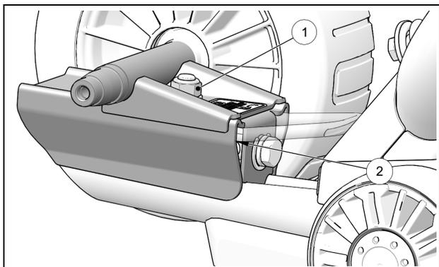
*NOTE : Une fois la graisse appliquée, faites bouger l'ajustement du boulon au minimum et au maximum de sa course. Réajuster ensuite la tension de la chenille selon les recommandations de ce manuel à la page 17.*
