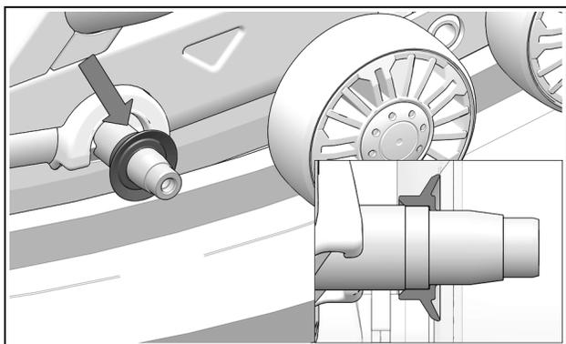
Appliquer 3 à 3.5 cc de graisse à la rainure en V du joint d'étanchéité, de façon uniforme sur toute la circonférence (360°).
