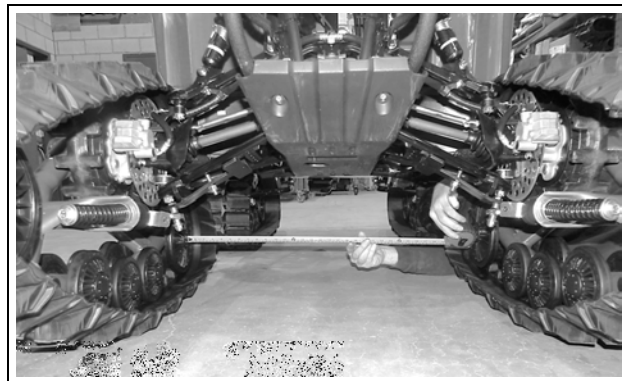
Figure 25 (Distance entre les roues arrière)
