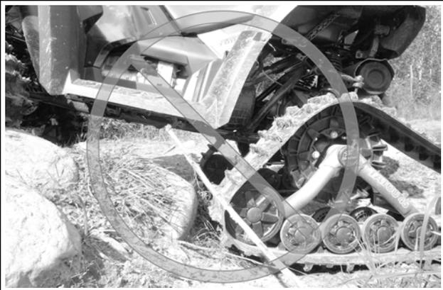
**ATTENTION :** Si une telle situation se présente, insérer une bûche ou une pierre de taille suffisante à diminuer la hauteur de l'obstacle et faciliter le passage.
