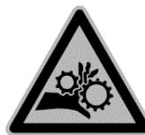
**Pièces mobiles** - Garder les mains ou les doigts loin des pièces en mouvement afin d'éviter les risques de blessures graves ou de mort. Couper le moteur avant de faire l'entretien du Système.
