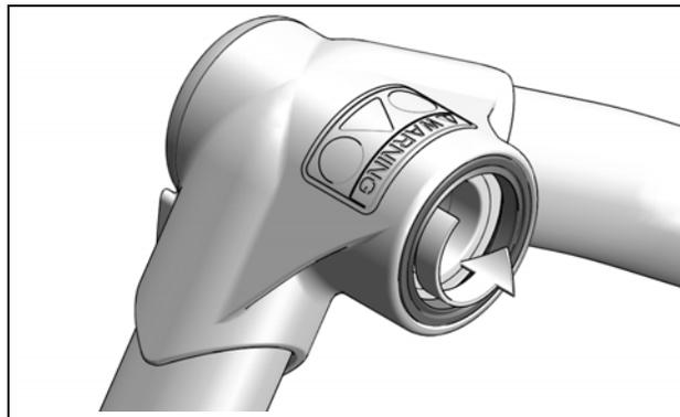
**IMPORTANT :** Le joint d'étanchéité du moyeu doit être inséré jusqu'à ce qu'il soit égal à l'extrémité du logement du moyeu.
