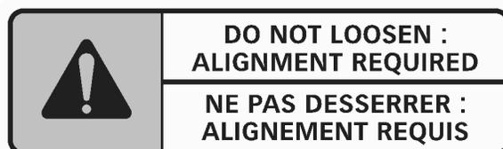
**Boulon du tendeur** - Le boulon de l'ensemble tendeur ne doit en aucun cas être desserré lors de l'ajustement de la tension de la chenille. Ce boulon permet d'assembler et d'aligner le tendeur au châssis. Le tendeur doit obligatoirement être réaligné si ce boulon est desserré.
