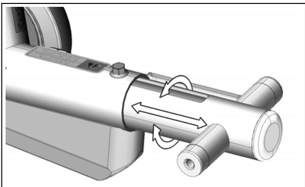
**NOTE :** L'application de lubrifiant à l'extérieur du tube du tendeur empêche la corrosion à l'intérieur du tube du châssis. La lubrification permet au tendeur d'être libre de mouvement lorsqu'on ajuste la tension de la chenille.
