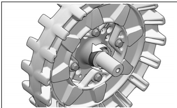
**ATTENTION :** Remplacer la bague d'acier inoxydable si elle montre de l'usure.
