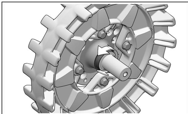
**ATTENTION:** Remplacer la bague d'acier inoxydable (N/P 1093-00-7003) si elle montre de l'usure.
