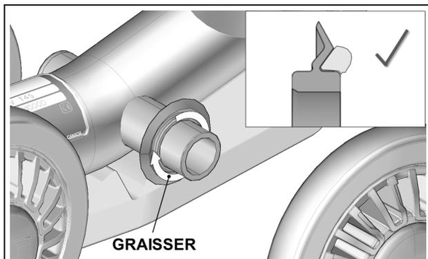
Lors des suivis de maintenance, Camso recommande d'appliquer 5 cc d'huile sous les capuchons de roue du système. Cette lubrification minimisera les risques de contamination et augmentera la durée de vie des roulements.
