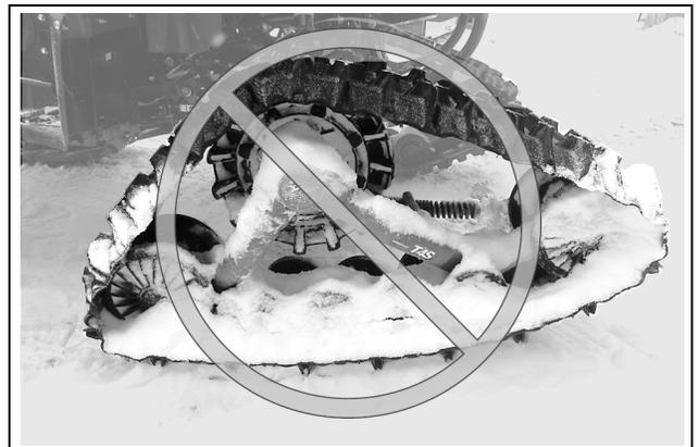
**ATTENTION:** Les systèmes de traction pour VTT projettent une quantité de neige, poussière, eau et boue plus importante que des pneus. Il est de la responsabilité du propriétaire d'adapter les entrées d'air Moteur et CVT du véhicule afin d'éviter les risques de pannes et/ou dommages aux composants mécaniques.
