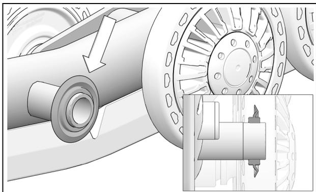
Appliquer 3 à 3.5 cc de graisse à la rainure en V du joint d'étanchéité des roues de Ø134 mm et Ø202 mm, de façon uniforme sur toute la circonférence (360°).
