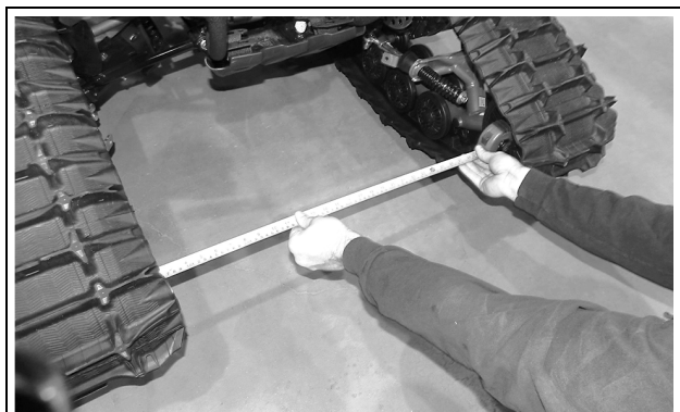
Figure 21 (Distance entre les roues avant)
