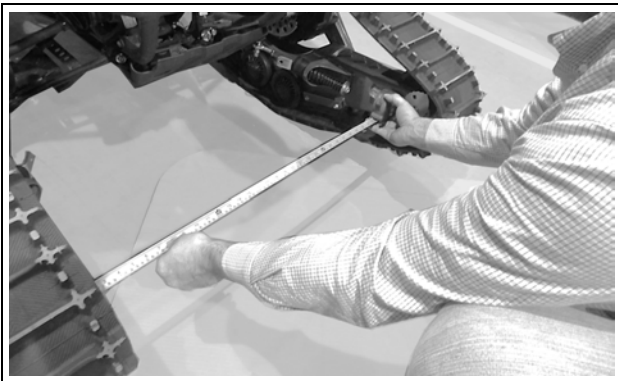
Figure 20 (Distance entre la partie avant des châssis)
