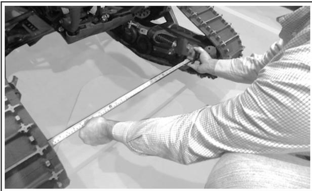
Figure 20 (Distance entre la partie avant des châssis)
