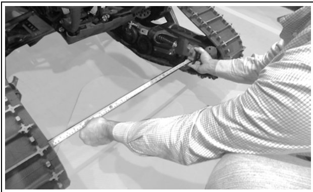
Figure 20 (Distance entre la partie avant des châssis)
