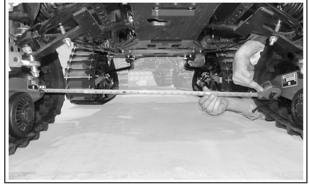
Figure 22 (Distance entre la partie arrière des châssis)
