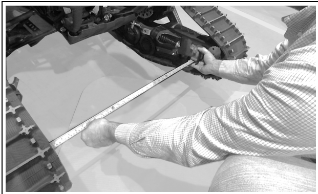
Figure 19 (Distance entre la partie avant des châssis)
